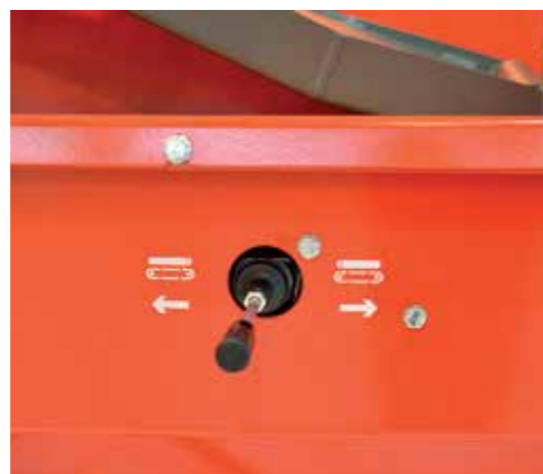
På Standard- og Deluxe-modellene er en reversventil på innmaterbelte tilgjengelig som tilleggsutstyr.
