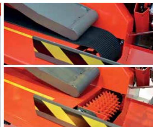
Hydraulisk drevet innmaterbord på Standard- og Deluxe modellen, piggvals innmater på Basic modellen.
